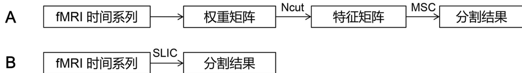
图 2.2 Ncut 和 SLIC 两种分割算法的流程图。(A) Ncut 方法。先基于 fMRI 时间系列构建权重矩阵，然后用 Ncut 从权重矩阵中提取特征，最后将 MSC 作用在提取得到的特征上来进行分割，从而得到分割结果。(B) SLIC 方法。直接将 SLIC 作用在 fMRI 时间系列上进行分割，即可得到分割结果。SLIC 方法不需要构建权重矩阵和提取特征的步骤。
